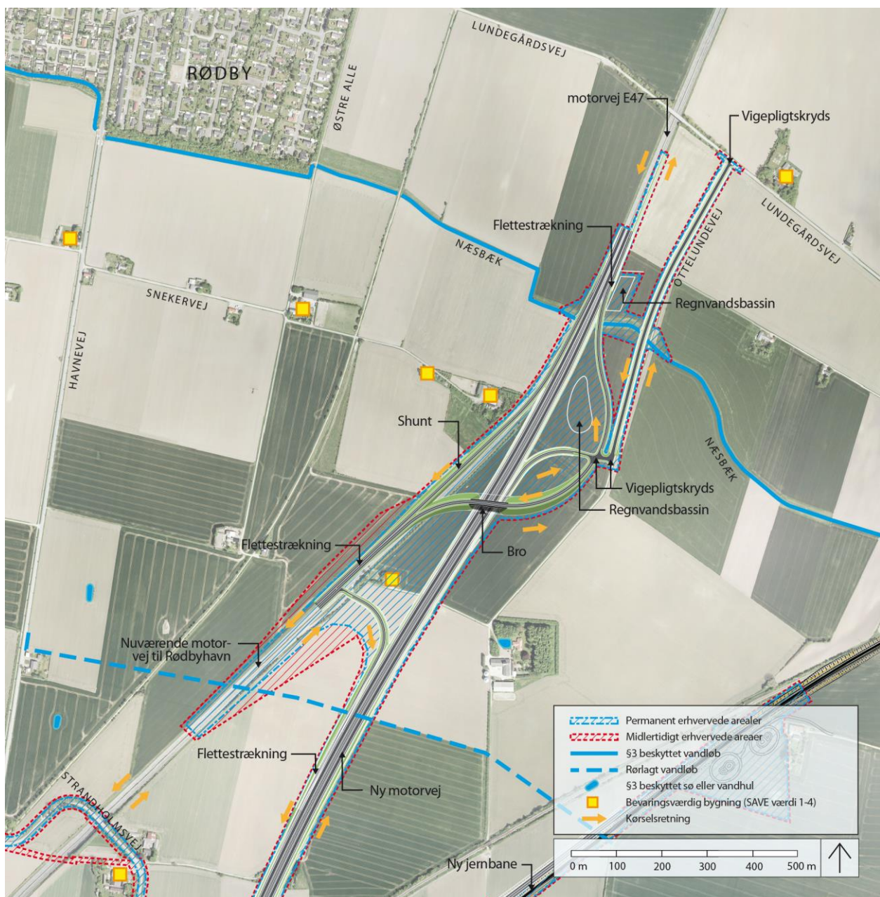
Figur 1 Udformning af tilslutningsanlæg ved Ottelundevej
